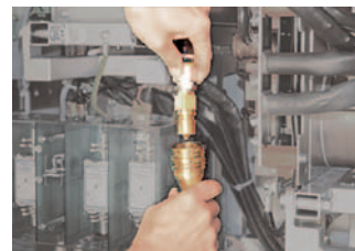
Die Flüssigkeitskühlung kann durch Schnellkupplungen schnell und tropfsicher getrennt werden.
